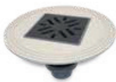
KRASO® Hof-/Parkdeckablauf Typ 1,5 mit Spachtelflansch mit Schwalbenschwanznut
